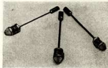
Bild 8. Fräsköpfe für das Reinigen von Hausanschlussleitungen (rechts)
